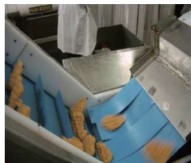
デュアルドライブベルト 横棧付&クッション材
